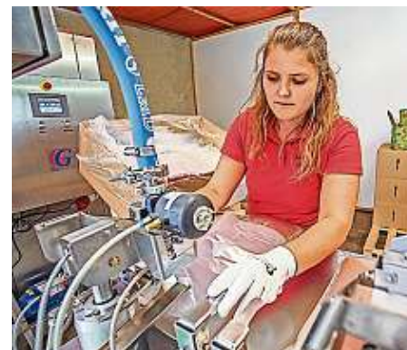
Jule Weber füllt den fertigen Saft in Beutel. Anschließend kommt dieser in Kartons.
