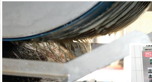
Unsere Bandpresse garantiert eine hohe Saftausbeute und Süßmost mit geringem Anteil an Schwebstoffen. Nach dem Pressen werden die groben Schwebstoffe mit einem Separator herausgefiltert.
